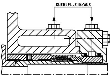
Gekühlte Wellendichtung mit einfachwirkender, entlasteter Gleitringdichtung bis +210 °C. Kühlung des Dichtungsraumes über Dichtungsgehäuse und kühlbarem Gegenring. Entlüftung über Drosselspalt. Wasseraufbereitung nach VdTÜV-Merkblatt TCH 1466/AGFW 5-15.
