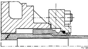
Ungekühlte Wellendichtung durch einfachwirkende, entlastete Gleitringdichtung bis +160 °C. Mit externen luftgekühlten Wärmetauscher bis +200 °C. Wasseraufbereitung nach VdTÜV-Merkblatt TCH 1466/AGFW 5-15.
