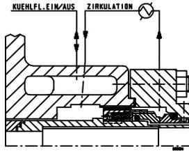
Gekühlte Wellendichtung mit einfachwirkender, entlasteter Gleitringdichtung bis max. +240 °C. Kühlung des Dichtungsraumes über das Stopfbuchsgehäuse und Produktzirkulation durch einen externen Wärmetauscher (Fördergewinde). Wasseraufbereitung nach VdTÜV-Merkblatt TCH 1466/AGFW 5-15.
