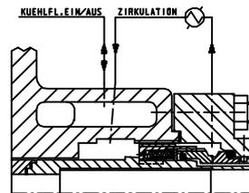
Gleitringdichtung einfachwirkend, intensiv gekühlt mit externem Wärmetauscher
