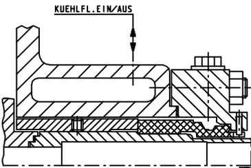
Gekühlte Wellendichtung mit einfachwirkender, entlasteter Gleitringdichtung bis +190 °C. Kühlung des Dichtungsraumes über Dichtungsgehäuse. Entlüftung über Drosselspalt. Wasseraufbereitung nach VdTÜV-Merkblatt TCH 1466/AGFW 5-15.
