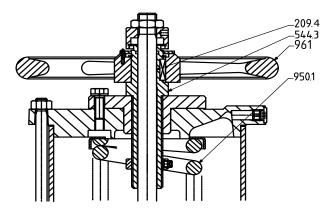
Figure 18: Fail-close actuator (LAP-SF)
